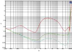
THD+N vs. output power at 100Hz, 1kHz and 6.67kHz  $^{\rm 4)}$  (4 $\Omega).$
